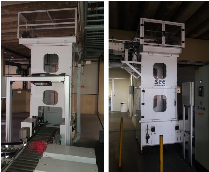
Figura 3: Plataforma Elevatória Externa
