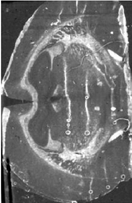
Figura 20 – Radiografia com partículas alfa induzidas por nêutrons de uma fatia histológica com 9 micras de espessura de cérebro de camundongo.
