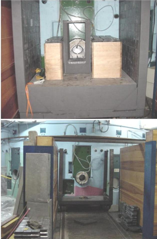
Figura 15 – Reestruturação do canal BH-8 do equipamento de radiografia com nêutrons. Detalhe da saída do feixe de nêutrons e as blindagens laterais de chumbo e de parafina borada e concreto.
