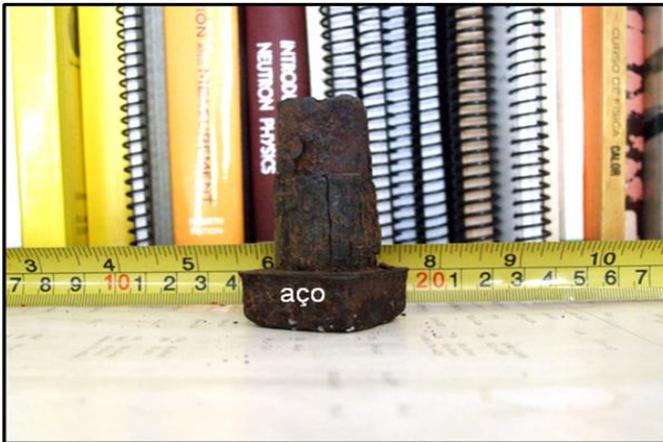
Figura 49. Parafuso com ferrugem tomografado.
