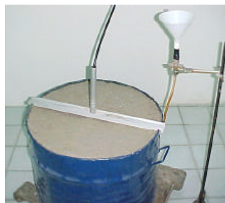
Figura 4. Tonel para calibração da sonda de nêutrons mostrando o sistema de alimentação de água.
