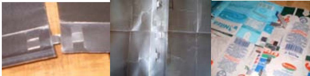
Figura 7 – processo das junções das placas usando faixas do mesmo material
