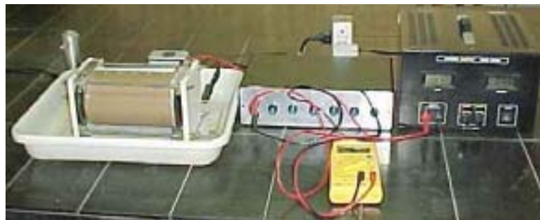
Figura 2 - Representação do conjunto reator cilindro para remediação eletrocinética.
