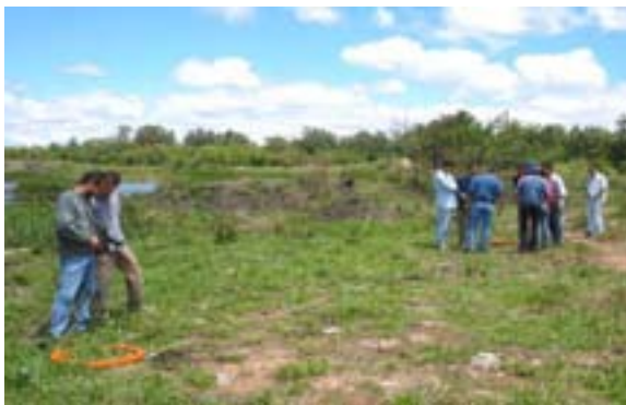
Figura 3: Operação do equipamento EM-34 para levantamento geofísico
