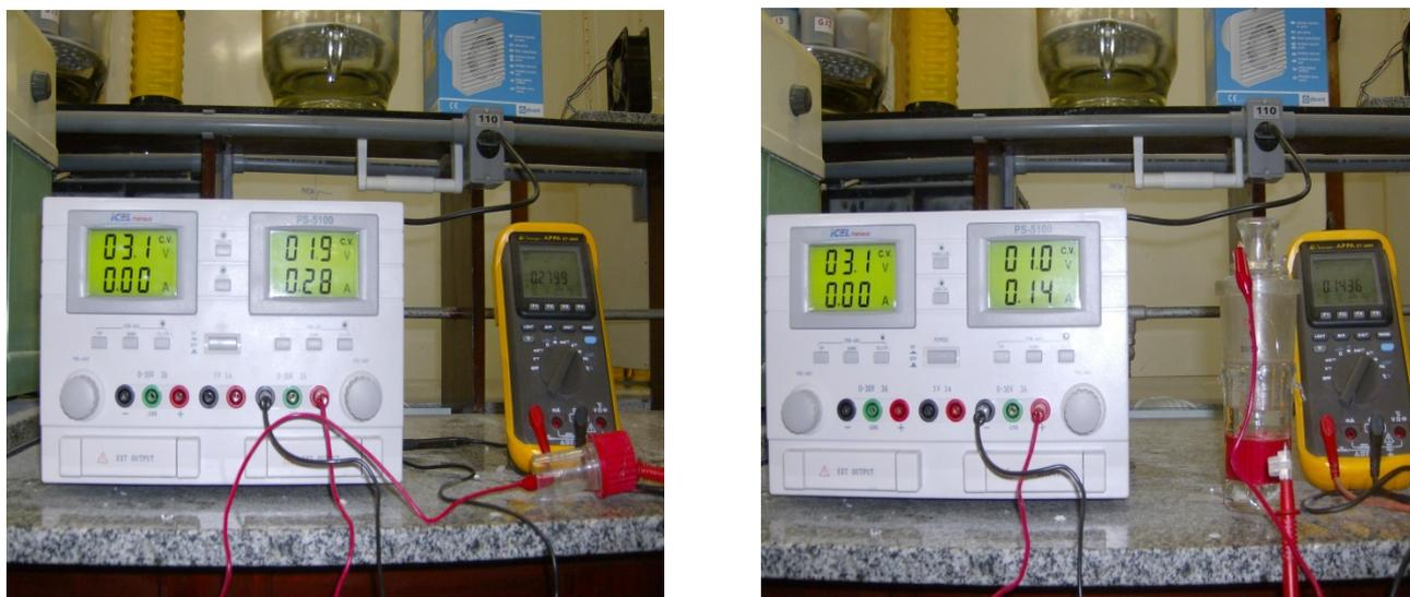
**Figura 1** – Fotografia com os respectivos sistemas: ar atmosférico e meio ácido 0,5M de HCl.
